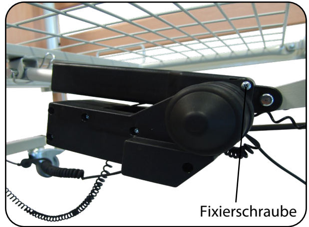
Abb. 6.2.02 - Steuerung an Rückenteilantrieb
